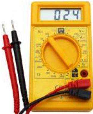
Um multímetro digital moderno (também conhecido como DMM) tem um mostrador numérico digital de LCD ou LED e várias chaves e/ou diais que permitem configurar o multímetro para medir um dos parâmetros disponíveis, como tensão CC, tensão CA, corrente CC, corrente CA ou resistência. Você verá símbolos no multímetro como os mostrados acima que representam esses parâmetros e as unidades de medida.
